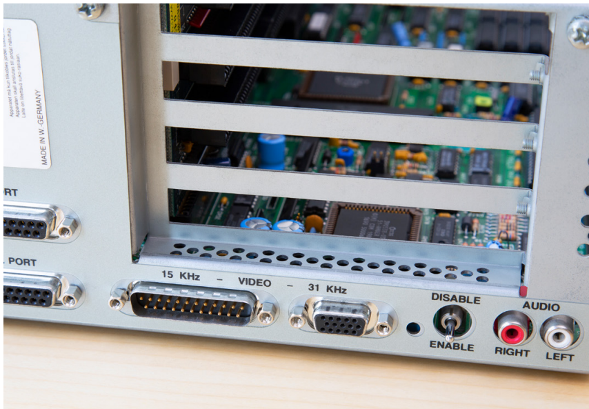
Amberin värinänpoiston pystyi kytkemään pois päältä Amiga 3000:n takana olevaa Disable/Enable-vipua kääntämällä. Itse piiri näkyy alimman korttipaikan luukusta.
